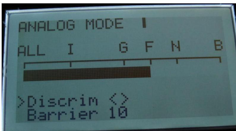
В данном режиме оперативно можно менять положение дискриминатора, отсекая не нужные металлы. Установка регулятора дискриминатора, осуществляется кнопками (-P и +P). При этом полоска дискриминатора будет показывать, какие металлы при этом будут вырезаны. Когда полоска в крайнем левом положении (ALL-все металлы), озвучивание будет происходить на все металлы. Далее под литерой (I-Iron), вырезается чёрный металл. Далее (G-Gold), вырезается слабо проводящие цели, как мелкое золото и т.д.
